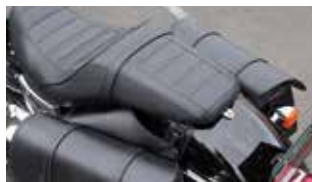
②シートを取り付け、バッグ下部の 取付ひもをサポートステー下部へゆ とりを持たせて結びます。
