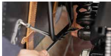
③バッグ背面下部の取付ひもをサポートステー 下部へ少しゆとりを持たせて結びます。
