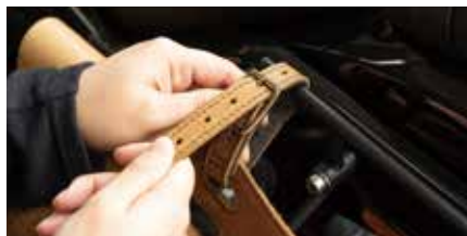
①取付ベルトをスライドレール、または一体型 サポートステーのベルト用穴に通します。
