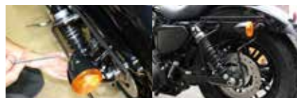
付属のボルト・カラーでサポートステーを装着 します。※スライドレール併用時は共締めします。
