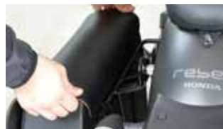
②ステー付きバッグを吊り下げ、R ピンをバッグ背面の固定ピンに差し 込みます。※脱落防止のため、定期的 に固定状態を確認してください。
