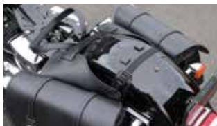
①シートを外し、ワタリベルトをリア フェンダーに渡します。面ファスナー で幅を調節し、リアサポートベルト で高さを固定します。
