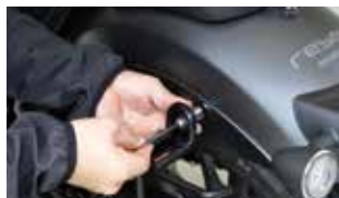
①リアフェンダーのボルトを外し、車 両側ステーを取り付けます。※取付 方法は付属の説明書をご確認ください。
