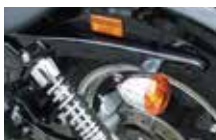
フェンダーストラットの ボルトを外します。
