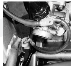
燃料キャッチタンクの パイピング
