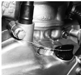
ワイヤーロック（緩み防止） ※ワイヤーは、ねじを締める方向へかけてください。
