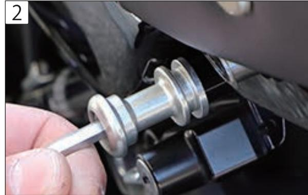
2 サイド部の純正カラー&ボルトを取外し、専用カラーを根元に挟んで再び固定し、純正カラー付け根に溝を作ります。
