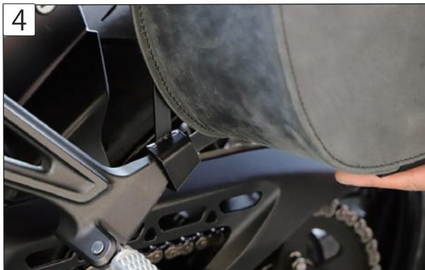
4 リヤステップステーの突起部分をバッグ下部の凹みに挿します。ゴムの抵抗があるので奥までしっかり入れてください。
