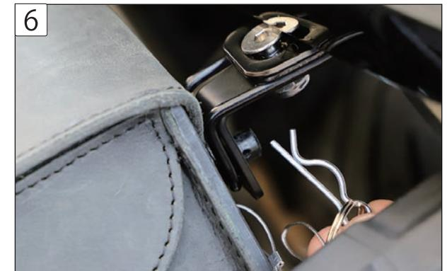
6 挿し込んだ円柱の穴に R ピンを挿入し車両にバッグを固定させます。バッグを軽く揺らし固定できている事を確認できれば、取付作業は完了です。
