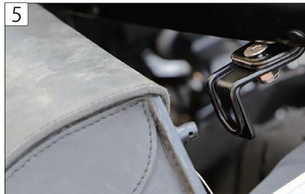
5 仮止めしていた専用L字パーツの穴に、バッグ側背面上部の突き出た円柱を挿入します。位置を確定させ M8-20mm ボルトを締め込み確実に専用L字パーツを固定します。位置が合わない場合は手順を再確認してください。
