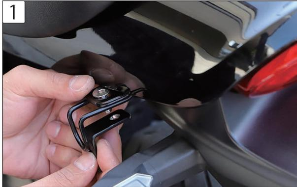
1 車両後方の荷掛けフック部に専用L字パーツを付属のM8-20mm ボルトとワッシャーナットで取付け、仮止めしておきます。
