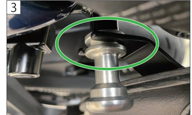
3 取付けた専用カラーで出来た溝部分に Z900RS 専用ステー上部の U 字部分を奥まで確実に挿し込みます。注意：専用カラーで作った溝以外にステーを挿さないでください。
